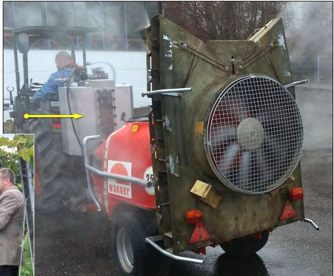
Automatisches Sprühsystem für Reben und Plantagen
